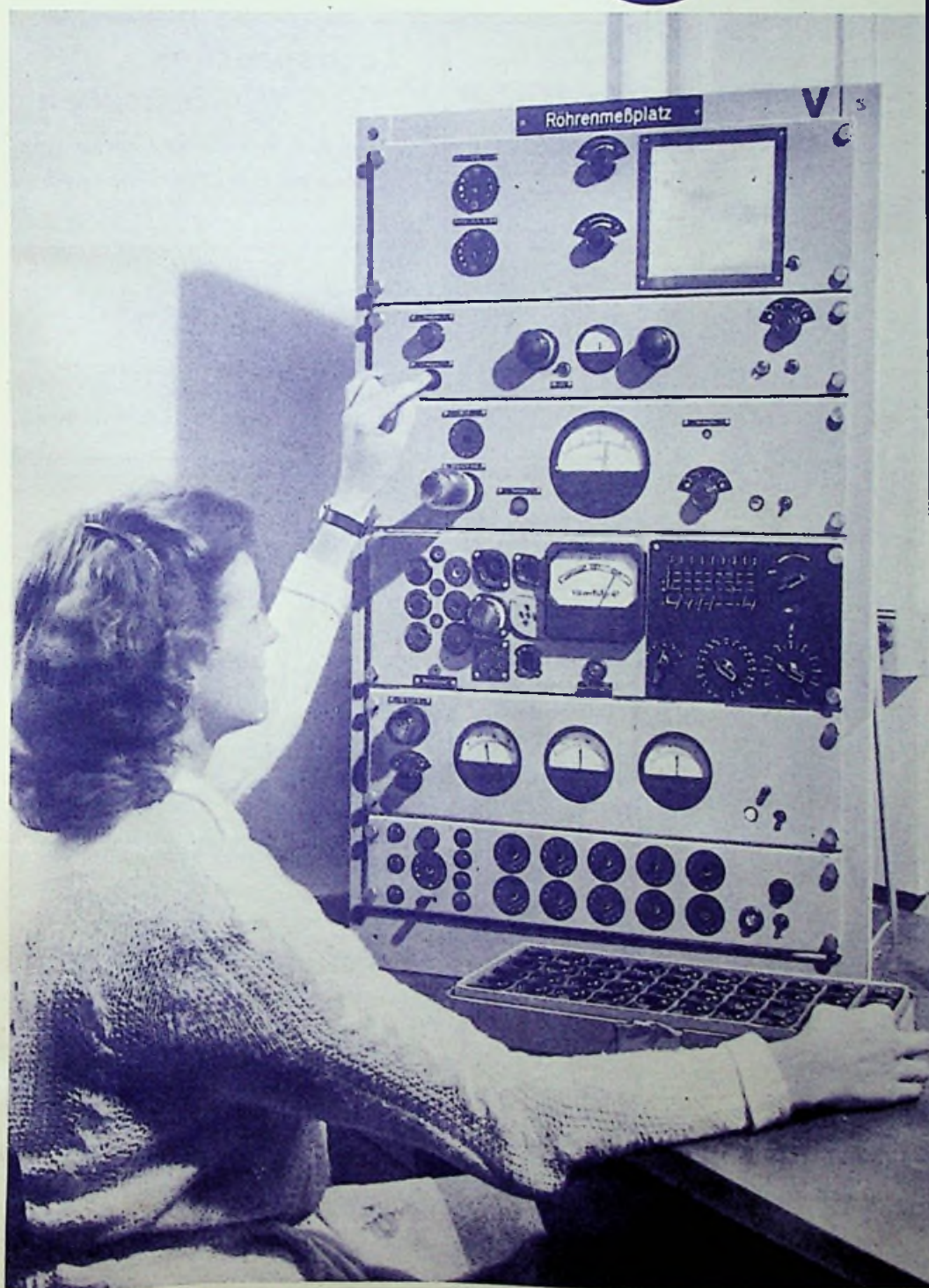
Das Prüffeld des Rundfunktechnischen Instituts in Nürnberg hat die Aufgabe, alle Geräte und die dazu erforderlichen Röhren, die in den Rundfunkbetriebsstellen verwendet werden, genau zu überprüfen. Auf diese Weise wird ausreichende Betriebssicherheit und hohe Qualität der Rundfunkübertragungen gewährleistet. Unser Bild zeigt Arbeiten am Röhrenmeßplatz des RTI-Prüffeldes.
